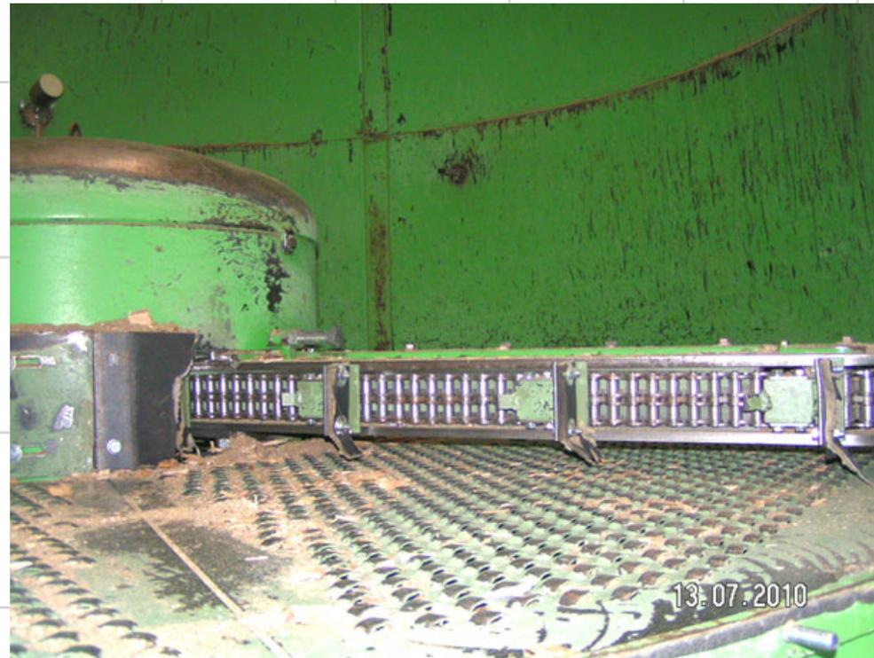
**Perforierter Lochboden mit Austragungsfräse**
