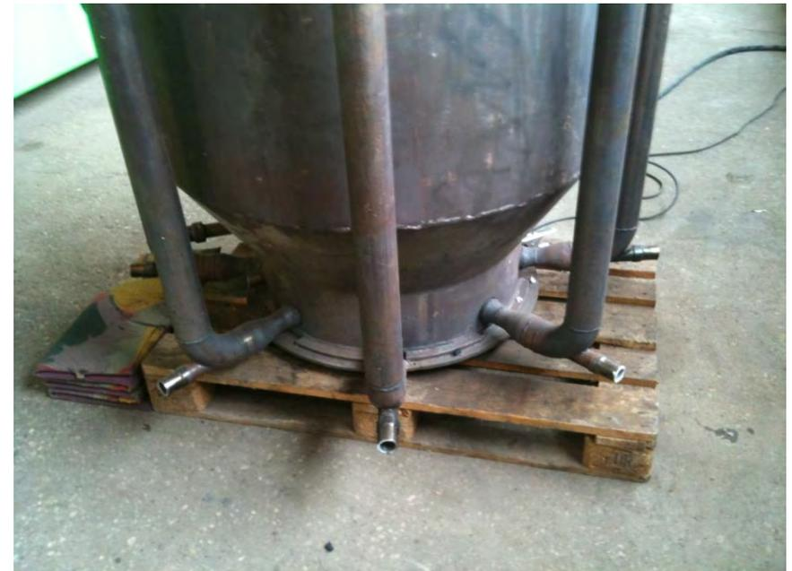
**Ausführung des erfolgreich getesteten 2 – stufigen REDOX - Reduktionsvergasers**
